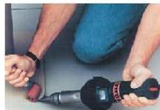
**TRIAC PID** sa jednom širokom diznom od 20 mm valjkom za pritiskanje prilikom zavarivanje plastinog elementa.
