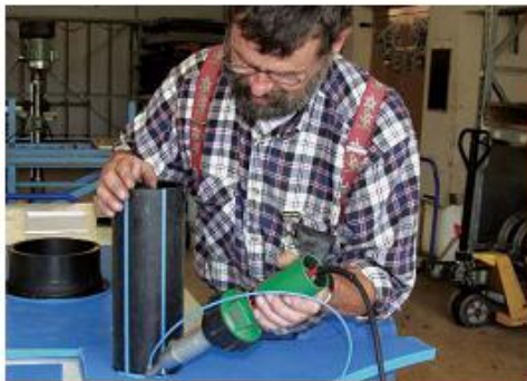
Varenje kalupa sa TRIAC PID i podignutom diznom za brzo varenje.
