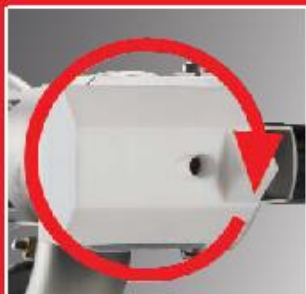
Podloška za zavarivanje se okreće za 360°
