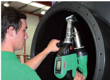
WELDPLAST S2 je i kod horizontalnog varenja jednostavan za rukovanje.
